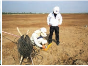
Quan trắc áp lực nước lỗ rỗng Pore water pressure monitoring
